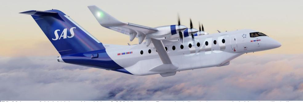
ES-30 har en fuldelektrisk rækkevidde på 200 kilometer. Der er installeret et reserve-hybridsystem til at sikre reserveenergikrav uden at kompromittere batterirækkevidden, og det kan også bruges på længere ture til at supplere den elektriske kraft, der leveres af batterierne. Dette giver ES-30 en forlænget rækkevidde på 400 kilometer med 30 passagerer og fleksibilitet til at flyve op til 800 kilometer med 25 passagerer, inklusive de typiske reserver, som fly skal have med.
